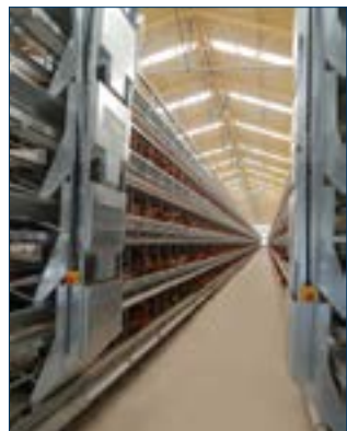
Figure 9. Les distributeurs à trémie déposent les aliments directement dans la mangeoire. Image: Alaso.
