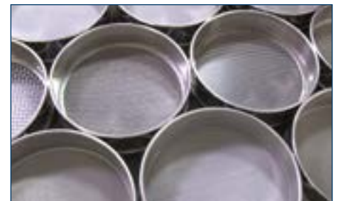
Figure 3. Tamis de différentes tailles utilisés pour séparer un échantillon d'aliment par taille de particule. Image: Gilson Company, Inc.
